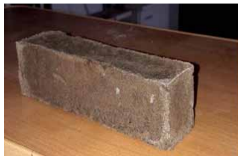
Рис. 6. Сапонит-базальтовый конструкционно-теплоизоляционный композит.
