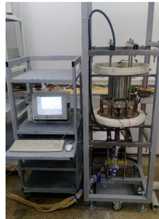
*Рис. 1 Ультразвуковой доплеровский анемометр DOP-2000 (слева) и установка для изучения элевровихревых течений на галлиевой эвтектике (справа) .*
