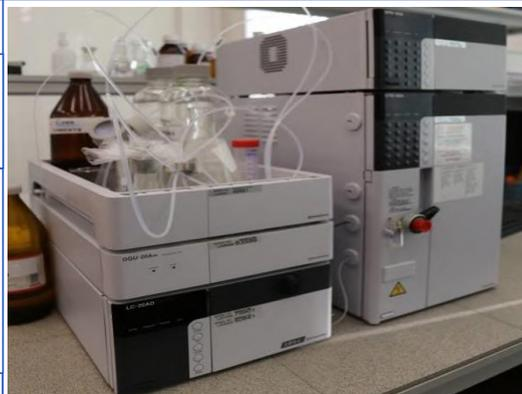
*Рис. 1 Высокоэффективная жидкостная хроматография*
