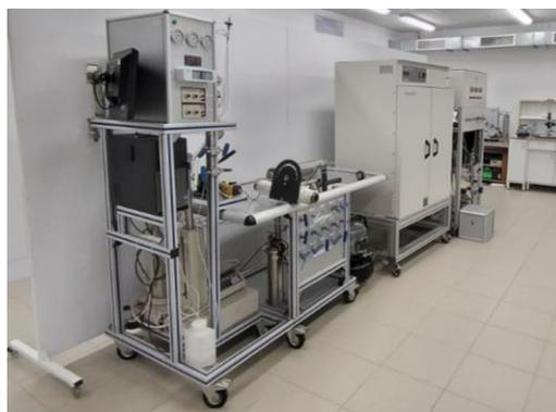
Рис. 1 Система для исследования керна
