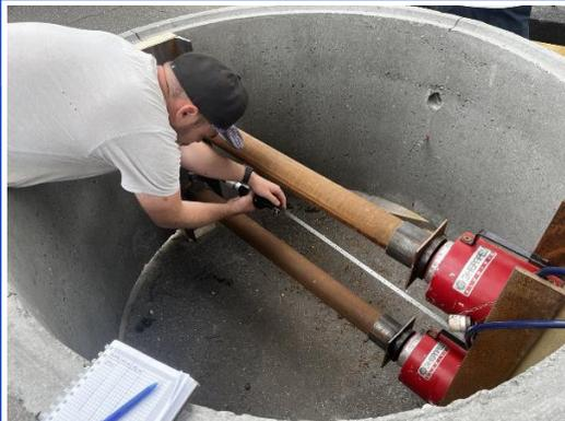
*Рис. 1 Лабораторные испытания системы распределённого измерения деформации на базе оптоволоконного кабеля*
