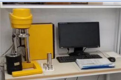
Рис. 3 Ротационный вискозиметр
