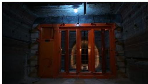
*Рис. 1 Автоматические вентиляционные двери - разработка отдела аэрологии и теплофизики*
