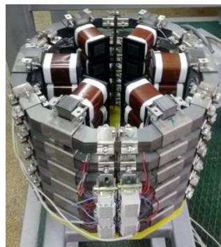
*Рис. 2 Электромагнитный многомодовый перемешиватель, размещенный в оловянно-свинцовом металлургическом стенде.*
