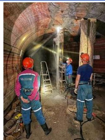
*Рис. 2 Экспериментальные исследования газоносности пород кровли, выполняемые сотрудниками лаборатории*
