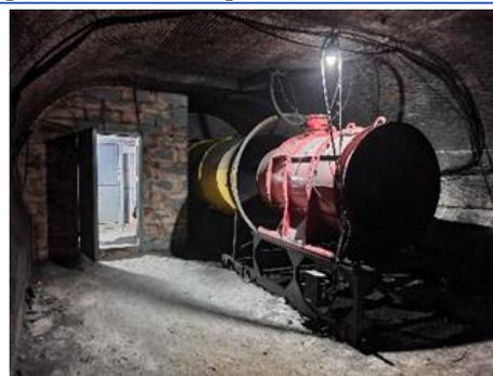
*Рис. 3 Шахтная вентиляционная установка - разработка отдела аэрологии и теплофизики «ГИ УрО РАН»*
