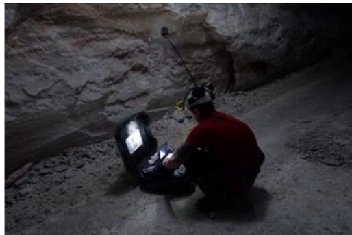
*Рис. 1 Телеинспекция скважины в стенке горной выработки калийного рудника, выполняемая сотрудниками лаборатории*
