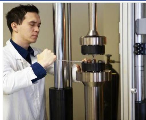
Рис. 2 Комплекс оборудования для высококачественного нагружения образцов
