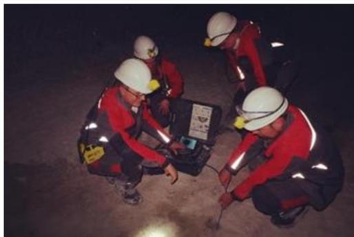
*Рис. 2 Телеинспекция скважины в почве горной выработки калийного рудника, выполняемая сотрудниками лаборатории*
