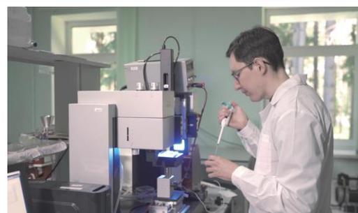
*Рис. 2 Определение краевого угла смачивания на гониометре*
