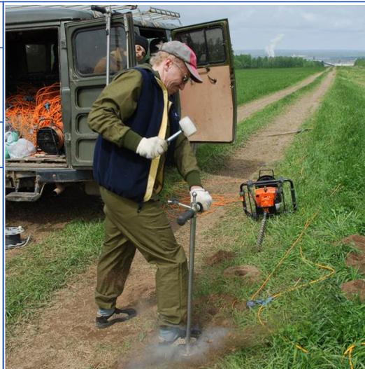
*Рис.1 Испытания импульсного порохового источника колебаний при малоглубинных сейсморазведочных работах*
