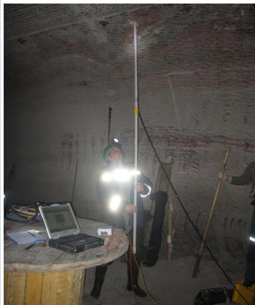
*Рис. 4 Шахтные сейсморазведочные исследования водозащитной толщи в соляном руднике*
