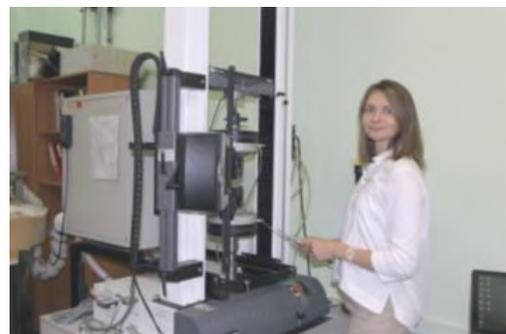
*Рис. 1 Испытания на разрывной машине*
