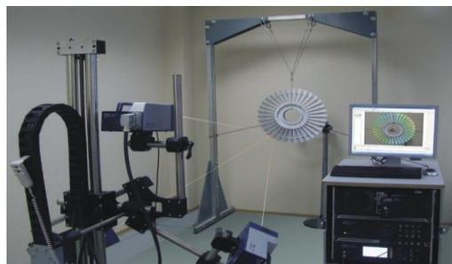
Рис. 1 Оптическая высокоскоростная система анализа полей динамических напряжений
