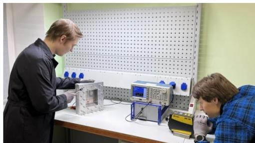
*Рис. 1 Подготовка к определению собственных частот колебаний*
