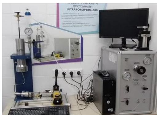
Рис. 2 Газовый пермеаметр/порозиметр
